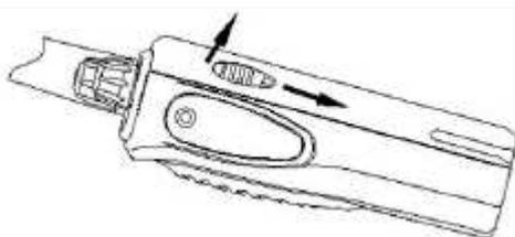
Для удаления блока аккумуляторов сдвиньте его слегка вниз, одновременно, потянув за специальные кнопки на боковых панелях аккумуляторного блока вверх.
