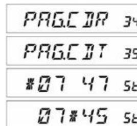
**FT-1802M** не распознает порядок следования тонов. Поэтому, например, пара тонов с номерами 10 и 35 идентична паре 35 и 10.
