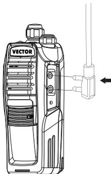
PS: При установке внешнего динамика/микрофона нарушается герметичность радиостанции.
