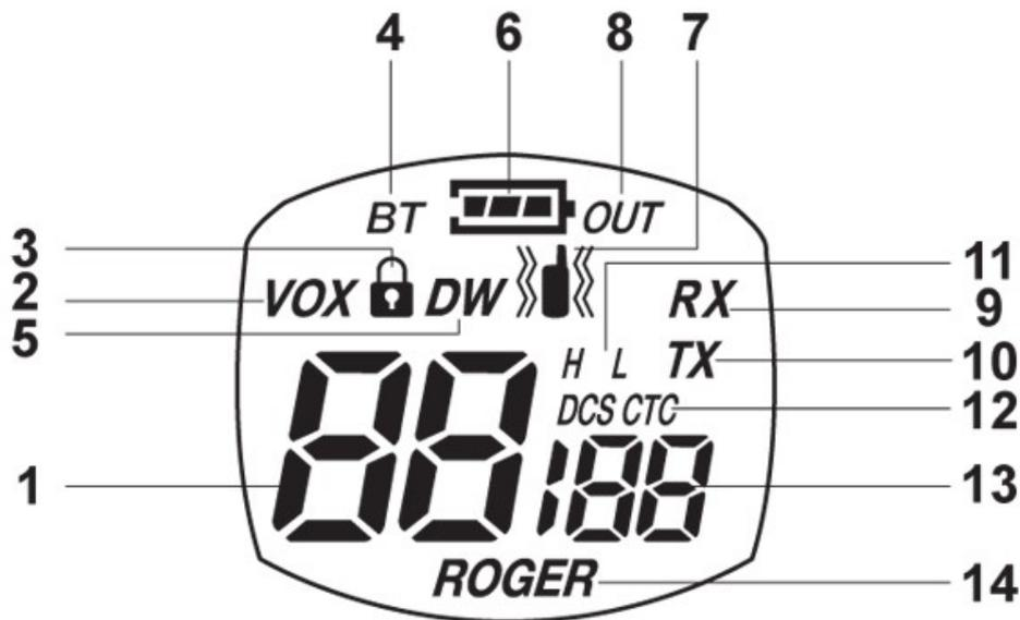
1. **88** в рабочем режиме эти большие цифры отображают номер выбранного канала; в режиме MENU - сокращенное обозначение пункта меню
